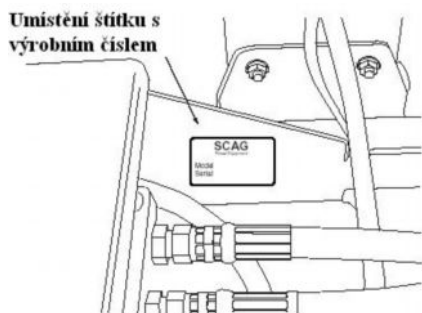
Obr. 1.1 Umístění štítku s výrobním číslem stroje
